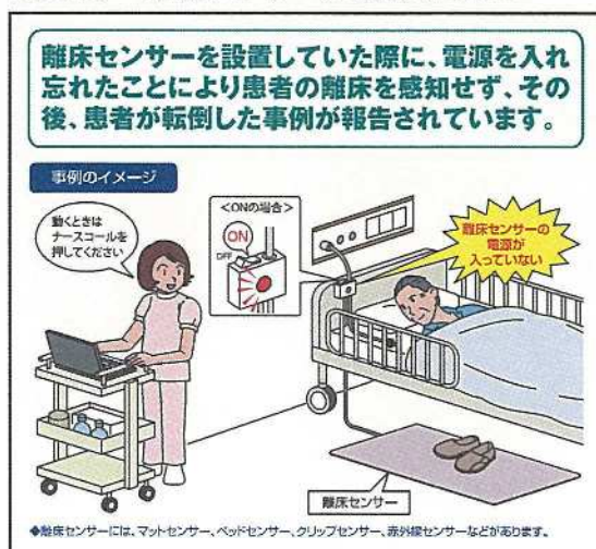
No.197 離床センサーの電源入れ忘れ
